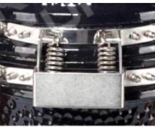
6. Пружинный механизм открывания
