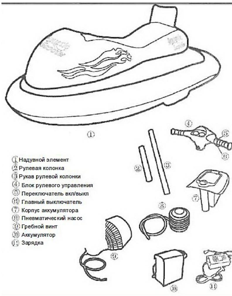
1. Подсоедините рулевую колонку к гребному винту. О правильном соединении рулевой колонки говорит характерный щелчок. Вставьте рукав рулевой колонки сверху в рулевую колонку.
